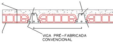
VIGA PRÉ-FABRICADA CONVENCIONAL
